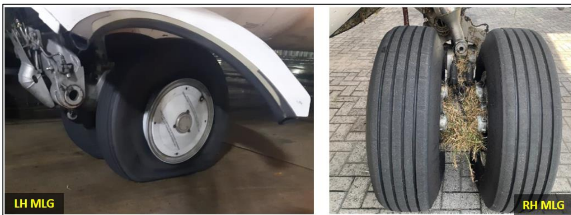
Fotografía No. 1: Condición de los trenes de aterrizaje - HK5040
